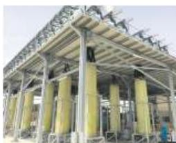
Il nuovo impianto di biofissazione intensificata della CO2 per la produzione di bio-olio algale
