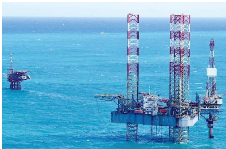
UN LAVORO IMMENSO A destra il Key Manhattan, l'enorme macchinario usato per chiudere i pozzi esauriti: viene trainato sul posto da tre rimorchiatori e a bordo ospita ottanta persone (Fotoservizio Fabrizio Zani)
