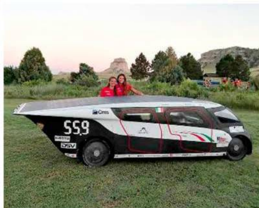
Emilia 4 è alimentata da cinque metri quadrati di pannelli solari ad alto rendimento: in tutta la gara ha consumato quanto un phon
